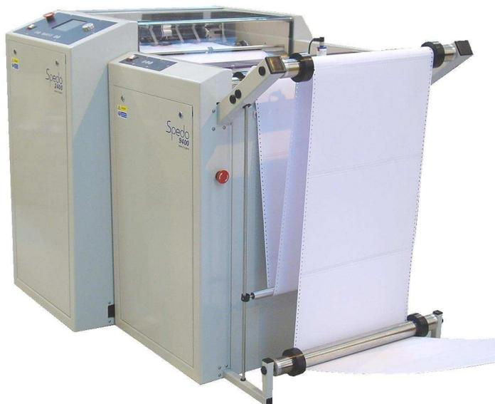
La gamme d'étage tampon Spedo a été conçue pour permettre de fonctionner en ligne avec les découpeuses de formulaires en continu standard, grande vitesse, dérouleurs et les équipements de traitement auxiliaires.
